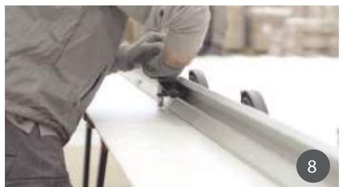
По окончании резки сместите плиту таким образом, чтобы линия надреза отступала от опорной поверхности на 10 см (9).
