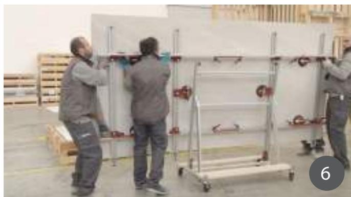
Закрепите направляющие на тележке для транспортировки плиты (7).
