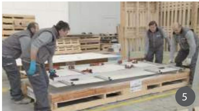
Используя рукоятки рамы, поднимите плиту длинной стороной вниз и поставьте ее в вертикальное положение (6).
